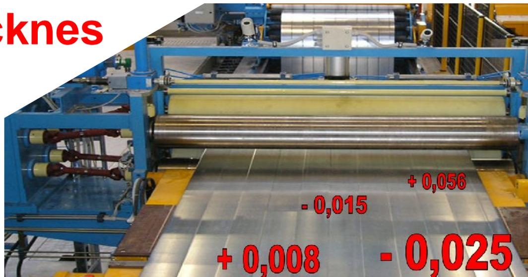
Utilizzando il sistema di misurazione **EFFE Thickness**, gli impianti siderurgici possono essere muniti di uno strumento per l'acquisizione di letture dello spessore su tutta la larghezza del nastro in modo completamente automatico.
